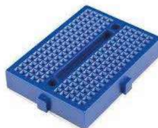
◆ MINI PROTOBOARD 170 PUNTOS ◆ PITCH 2.54mm
