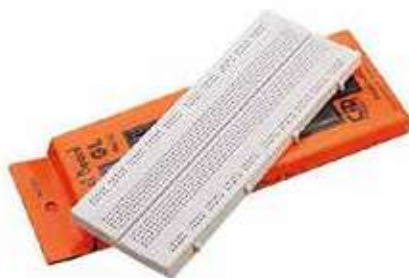
♦ MINI PROTOBOARD 830 PUNTOS ♦ PITCH 2.54mm
