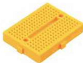
◆ MINI PROTOBOARD 170 PUNTOS ◆ PITCH 2.54mm
