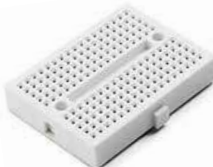
◆ MINI PROTOBOARD 170 PUNTOS ◆ PITCH 2.54mm
